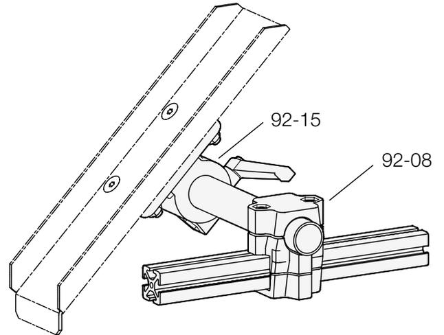
Goulotte de guidage montée sur structure en profilé aluminium
