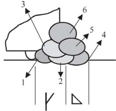
**1** - Souder le premier support de l'anneau. Les plots d'écartement sur les supports garantissent le jeu nécessaire pour la passe de fond de chanfrein. Pour rappel, ces plots ne doivent absolument pas être retirés. Commencer le soudage au point «S» (cf image). Avant de procéder à la passe de soudure en angle, bien nettoyer le cordon de fond de chanfrein. La passe en angle doit être exécutée selon la cote «a» (cf tableau de la page précédente).
