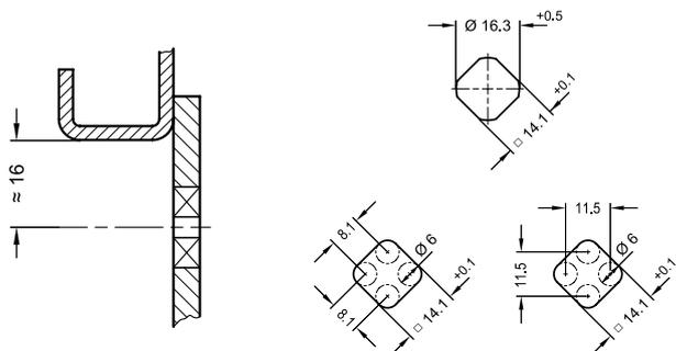
Pour l'installation du loquet, effectuer un perçage dans la porte comme indiqué sur le schéma ci-contre.
