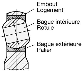
**Embout version acier :**Type **Acier / Laiton****Bague intérieure / Rotule :**
