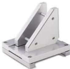
Le **kit de connexion 90-23** se compose de 2 plaques qui permettent de combiner 2 unités linéaires selon un assemblage en X-Z (ou Y-Z). Si l'unité linéaire doit être parallèle à l'axe de référence, il faut utiliser une plaque supplémentaire (choisir le modèle 90-23 «configuration parallèle»).
