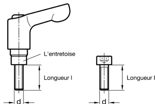
**2** - Démontez ces vis 6 pans creux et les remplacez par des manettes indexables de même longueur  $l$  et même diamètre  $d$ .
