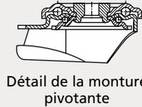
Détail de la monture pivotante
