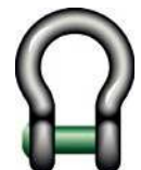
18-171 Manille lyre avec axe vissé à trou carré, haute résistance, grade 60
