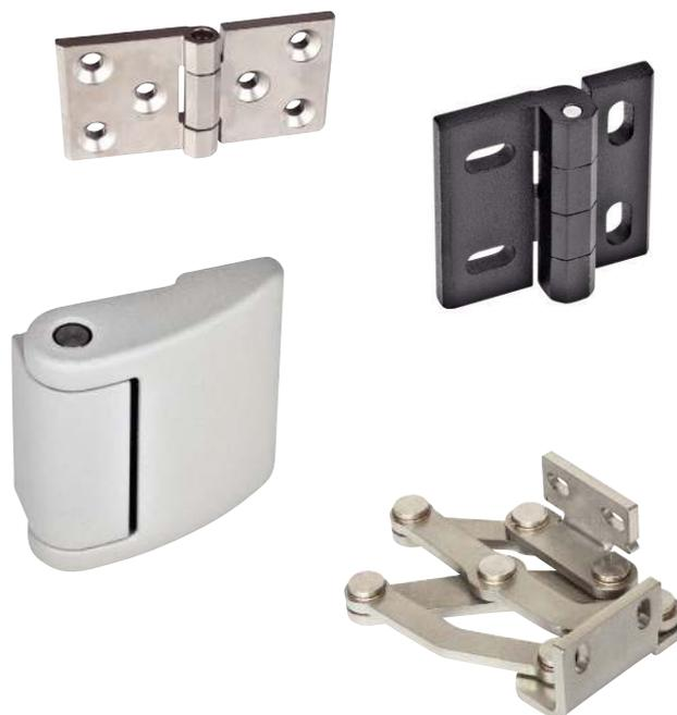
Emile Maurin ESM propose aussi des charnières avec une cinématique pointue : la charnière à articulations multiples avec un mécanisme qui permet d'ouvrir les volets ou portes et d'en modifier la position. L'angle d'ouverture est de 180° et le montage intérieur se fait aussi à l'aide de trous oblongs pour ajuster la position en verticale ou horizontale.
