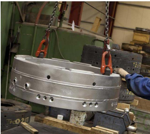
Les nouveaux anneaux à double articulation apportent de nombreux avantages comme un alignement automatique avec la manille ou l'élingue, une traction linéaire et perpendiculaire, une rotation sous charge lors de la manutention, une Charge Maximale d'Utilisation élevée (CMU) et un code de traçabilité directement gravé sur chaque anneau.
