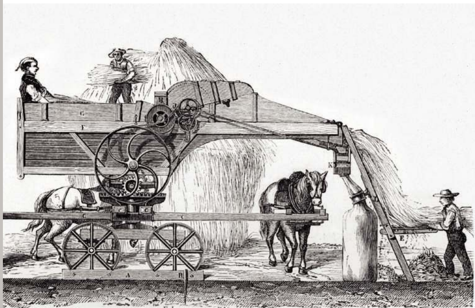
Fig. 349. — Batteuse Damery à manège direct placé sous la batteuse. Ech. 0m 020 P.M.
