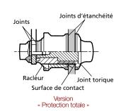
D'autre part, le modèle 19-171 « Protection totale » comporte des joints supplémentaires, également du côté de la came.
