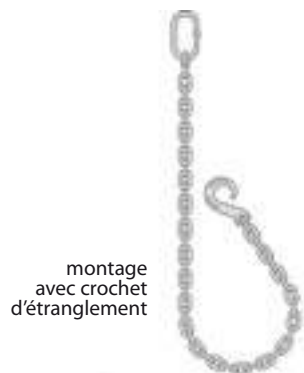
Figure 41 - Élingage en levage bagué
