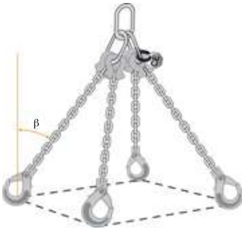
Figure 1 - Angle d'élingage \beta
