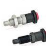
S'utilise lorsque l'on veut éviter le mouvement intempestif de la goupille du doigt d'indexage. La goupille est verrouillée dans la position sortie (32-86) ou rentrée (32-97) et ne peut être déverrouillée qu'en appuyant sur le bouton poussoir rouge de sécurité.
