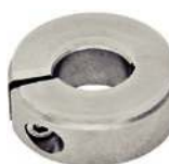
31-142 Bague d'arrêt fendue simple, inox , avec rondelle d'amortissement
