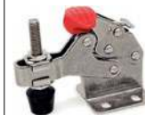
26-134 NOUVEAU Sauterelle verticale compacte, inox , à embase horizontale, avec ou sans bouton de verrouillage
